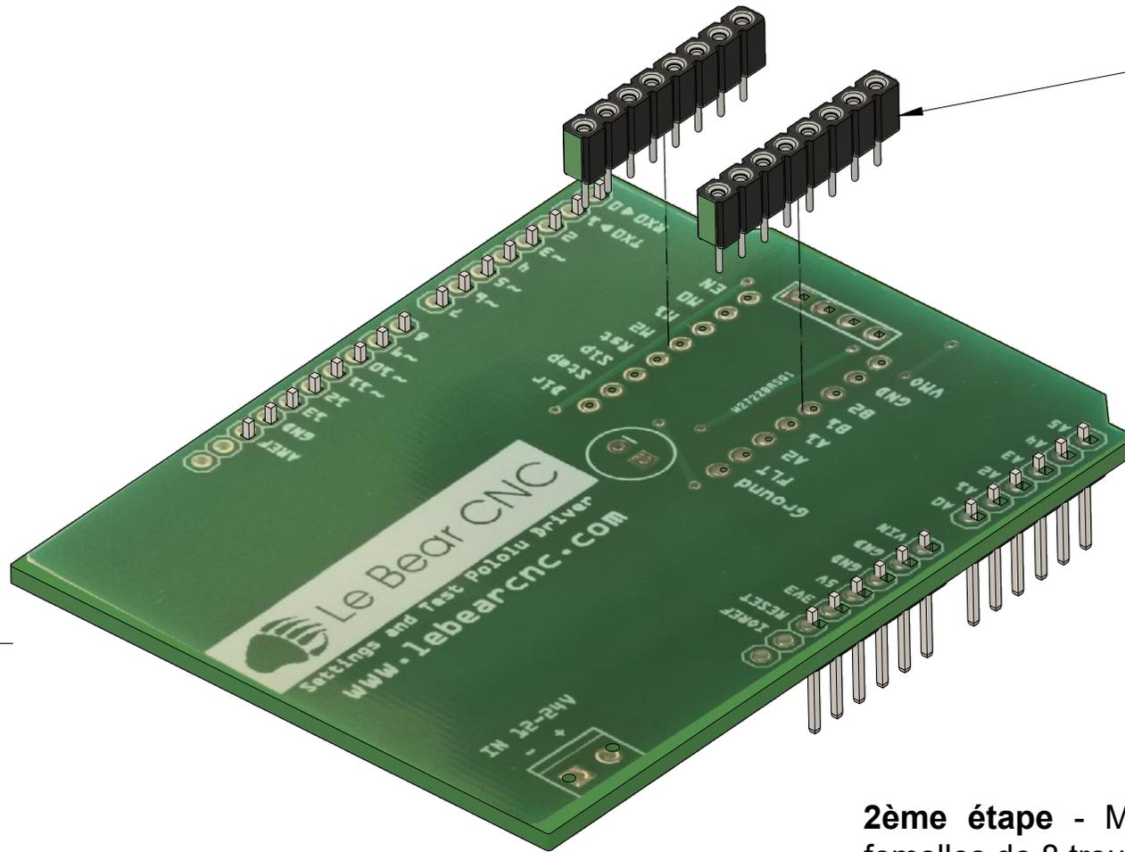
**2ème étape** - Mise en place et soudure des 2 barrettes femelles de 8 trous, destinées à supporter le driver Pololu.
